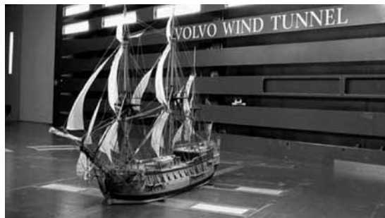
Figura 32. Modelo do navio Gotheborg em testes no túnel de vento da Volvo (Olsson, 2005)
