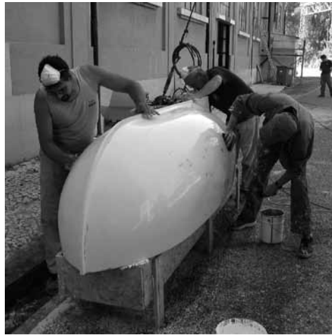
Figura 47. Modelo para testes em Canal de Ensaio Hidrodinâmicos
