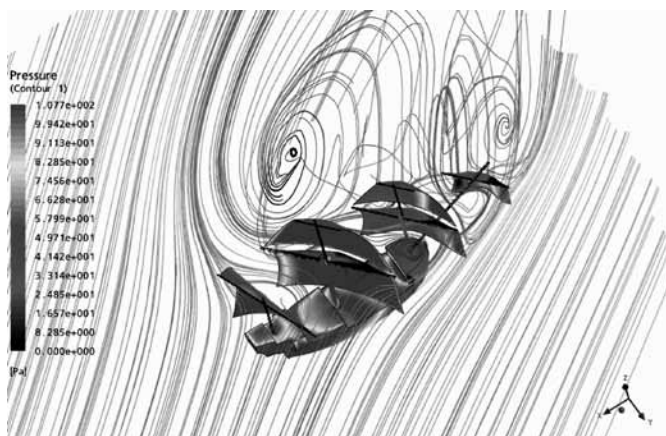
Figura 46. Linhas de corrente em torno das velas e obras mortas da NSM e escala de pressões dinâmicas sobre a superfície das velas e casco.
