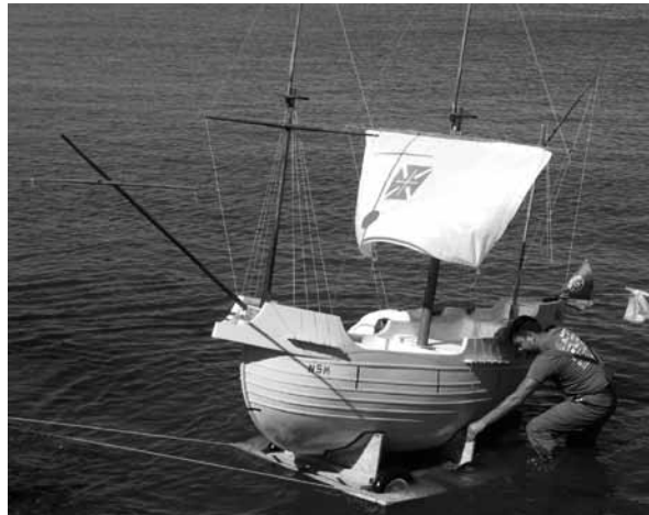
Figura 48. Modelo para ensaios semi-autónomos no mar
